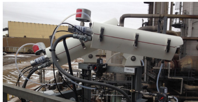
O ThermalSpecion em seu alojamento de proteção. Conexões de energia, comunicação e ar presentes numa única mangueira.
